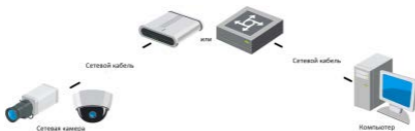
Рисунок 3-2 Подключение через коммутатор или роутер
